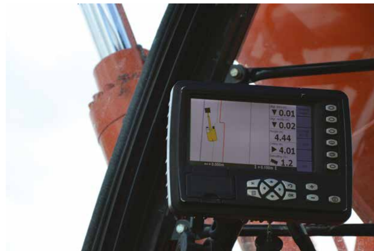
Fig. 2 Indication de la position du godet de la pelleuse.
